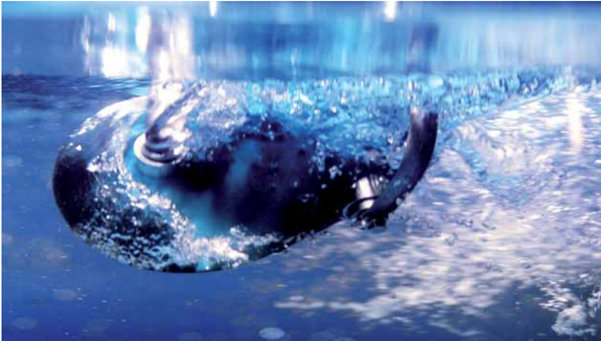
200 mm langes Oloid, Luftsauerstoff von der Oberfläche einziehend, niedrige Umdrehungszahl
