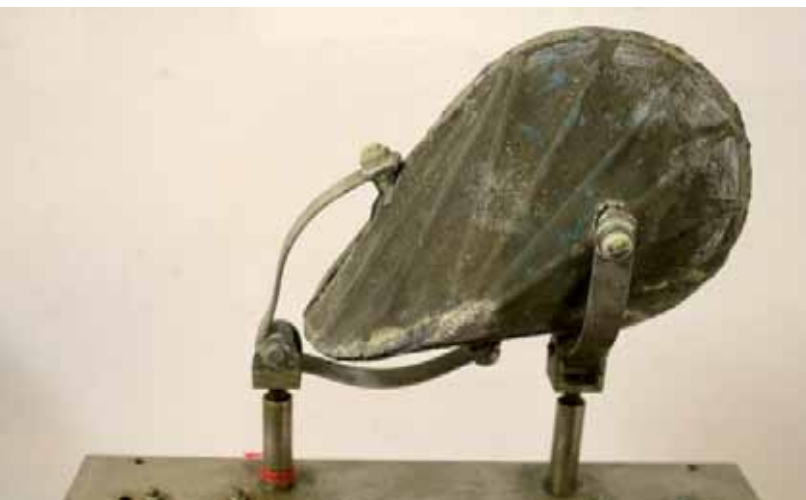
Prototyp von Paul Schatz, perforiertes Sieb-Oloid mit Silberwolle
